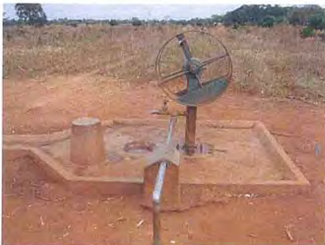
Khongoni 村 (Khongoni TA) 保健所近傍の井戸。スパウトに取り付けられたバルブを閉じると、手前のパイプを通じて保健所の高架貯水槽に水が揚げられる仕組みになっている。一見放棄井戸かと思われたが、ホイールを数十回回転させるうちに水が出てきた (右写真)。ポンプのシリンダーバルブ水漏れのため、揚水管内の水位が下がっていたことによる。
