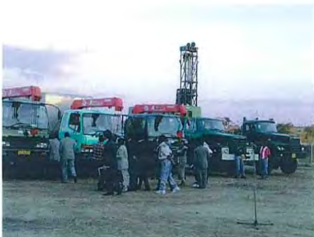
調達機材視察中の引渡式出席者。右手から掘削機、エアコンプレッサー、クレーン付カーゴトラック、移動式ワークショップ。
