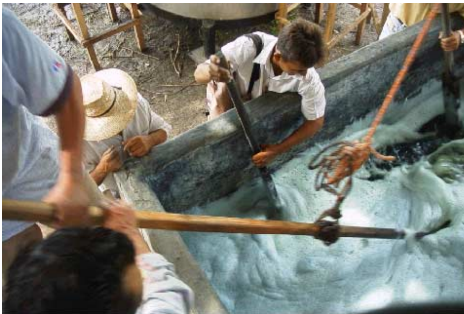
4 Oxigenación en el segundo nivel del obraje
