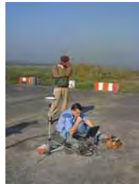
写真 5.2.4 “GPS 航空写真撮影用の GPS 点”
