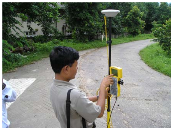
図 19.2.2 RTK 測量システム（移動点）
