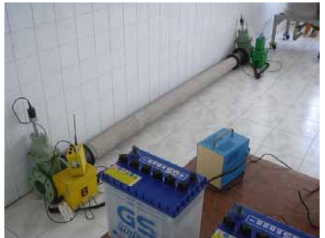
GOGCWSモストロッド訓練センター 漏水探知機（相関式）
