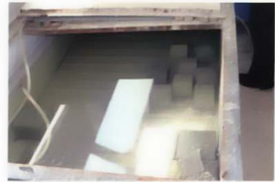
セメント・コンクリートユニット コンクリート試験サンプルの養生
