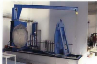
建材・断熱材ユニット 管の内圧試験機
