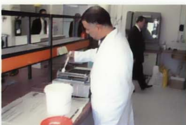
塗料・溶剤ラボ 塗料の伸び試験
