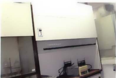
化学分析ユニット (化学分析ラボ) ケルダール分解器とドラフト
