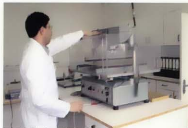
セラミックユニット タイルの曲げ試験
