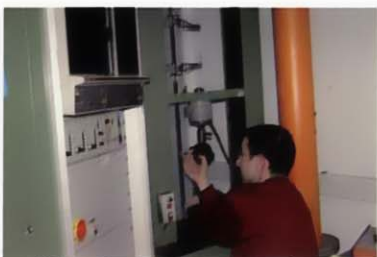
プラスチック・ゴムユニット プラスチック引張試験
