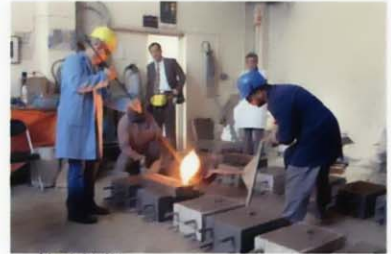
鑄造技術ユニット 鑄型への流し込み
