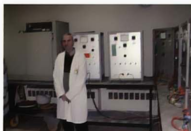
鉛蓄電池の試験装置
