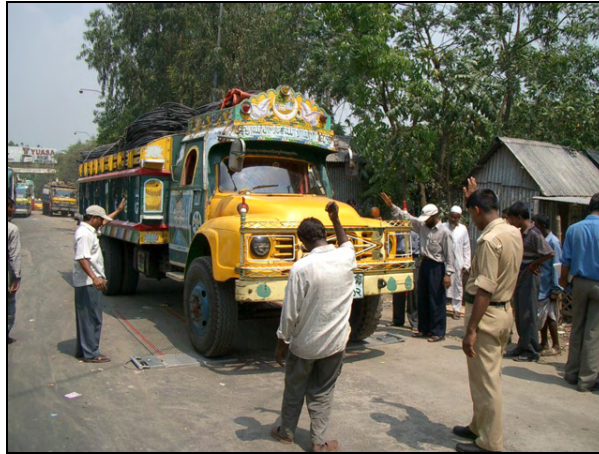
写真 1-2-2 軸重調査の様子
