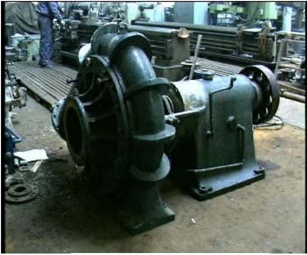
配水（遠心）ポンプの修理(1)
