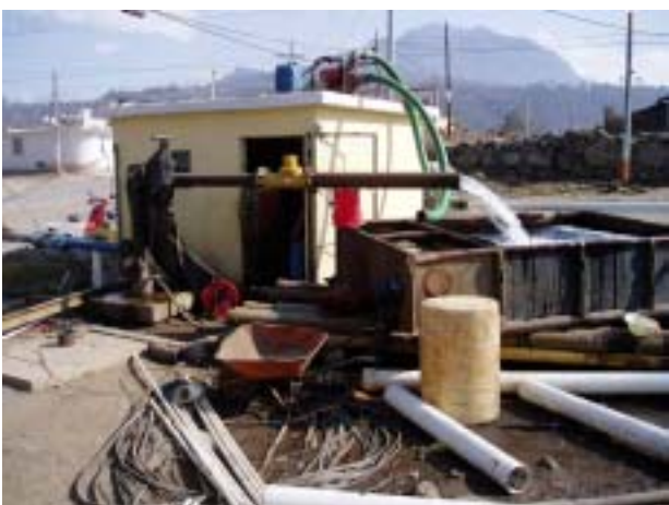
パカハ井戸揚水試験 現地再委託により既存井戸の揚水量試験を実施。35ℓ/秒の適正揚水量が確認された。
