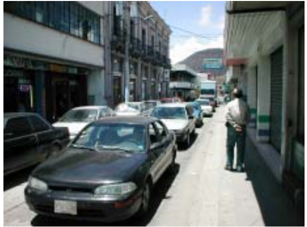
市街の典型的な街路（1区） 市街中心部街路の幅員は狭く、車両の通行による交通量が多い。舗装はコンクリートかインターロックブロック。
