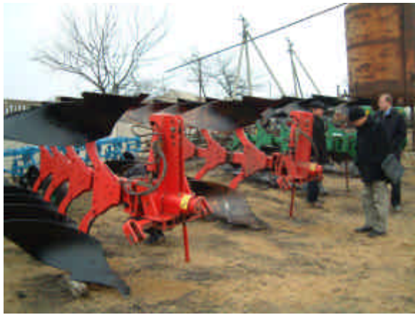
写真 3 2KR で調達されたイタリア製リバーシブル・ボトムプラウ
