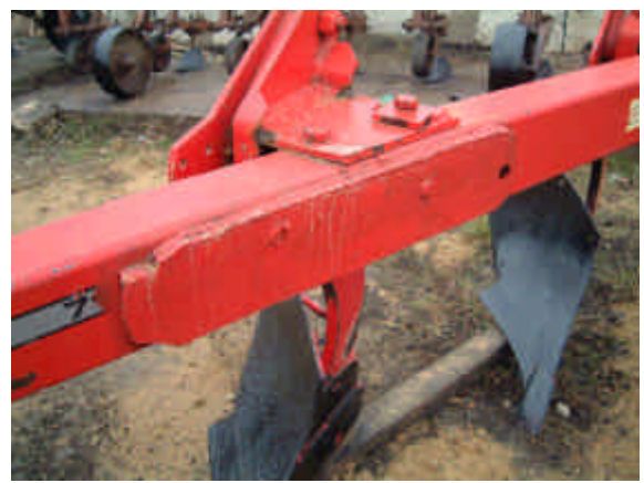
写真 4 リバーシブル・ボトムプラウのビーム破損箇所（2KR 調達品、修理済み）
