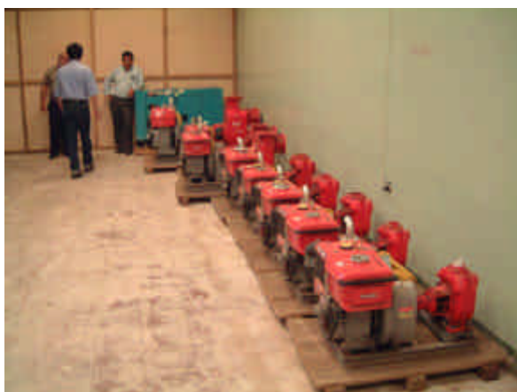
写真11 ヒノテガのPOLDES支所に保管中の灌漑用ポンプ(1999年度2KR調達品)
