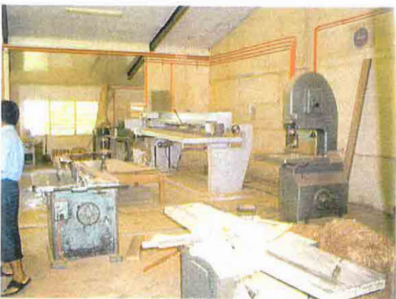
木工建具科。集塵機が機能しておらず、非常に劣悪な環境となっている。
