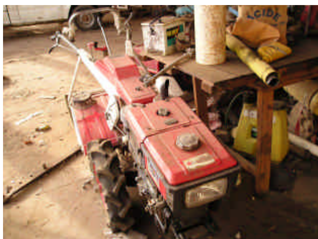
DPV 倉庫で修理中の歩行用トラクター （ルフィスク市）
