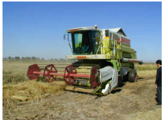
脱穀作業を行うドイツ製コンバイン。一旦刈取り、圃場にて乾燥させた後、コンバインにて脱穀する。 ホレズム州 ベルニ地区シェルカートにて
