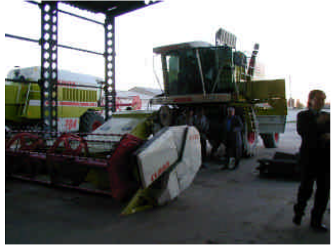
コメの収穫用に出動するために、小麦刈り取り用の脱穀ドラムと選別網を交換する作業を行っている。社車両基地にて
