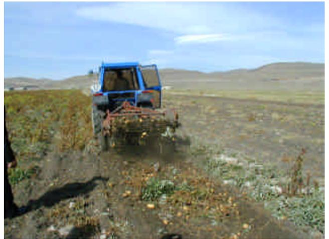
2KRにて調達したニューホーランド製トラクターとポテトディガーによるジャガイモの収穫作業
