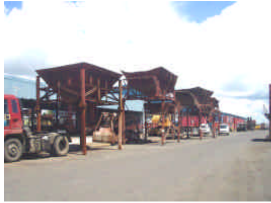
写真8 イロイロ州肥料業者が所有する肥料袋詰め用ホッパー
