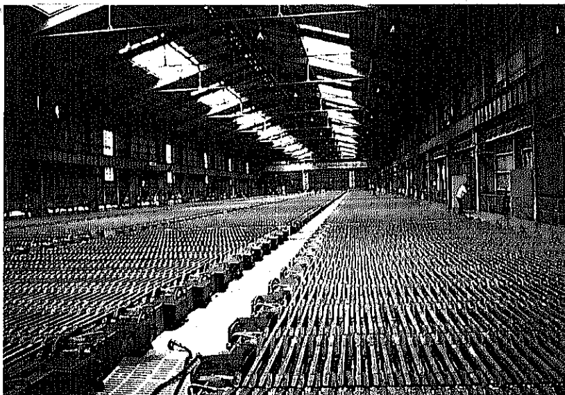
電気製錬工程 9日間かけて98~99%の銅 を99.99%の電気銅にする。
