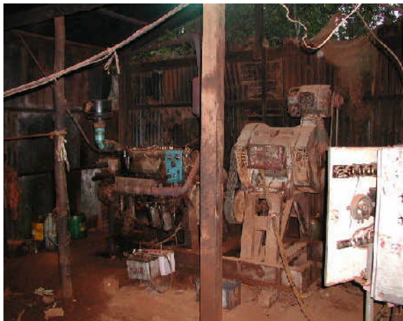
製氷業者が所有している 発電用ディーゼルエンジン
