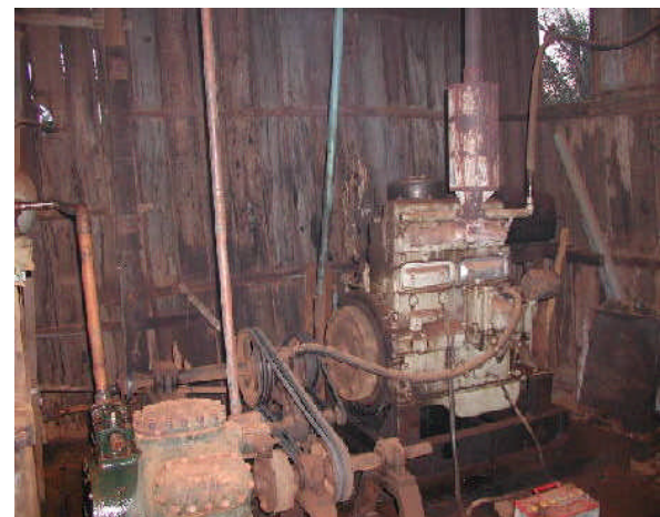
製氷業者が運営している製氷用 コンプレッサーとディーゼルエンジン
