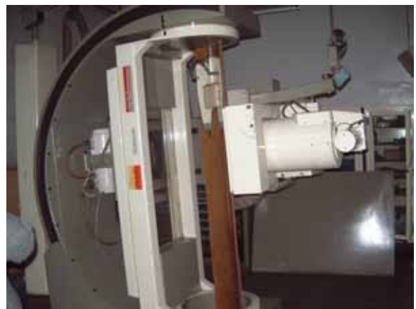
放射線科：X線透视撮影装置 カセット部分の破損により、透視のみに使用
