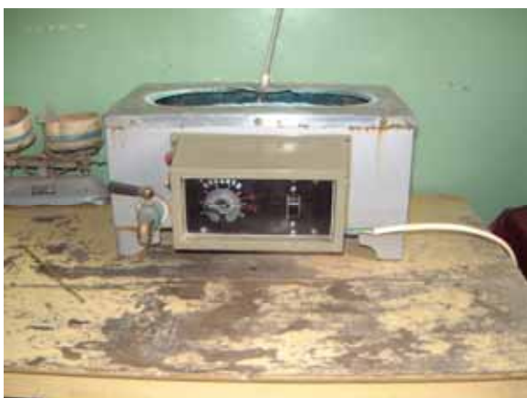
検査室：恒温水槽 故障により、現在使用不能
