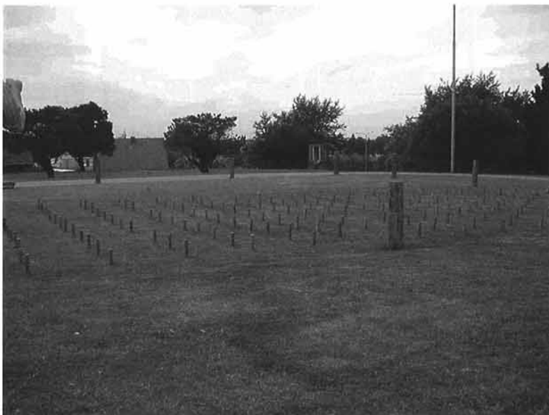
試験状況確認 (野外杭試験による腐朽及び蟻害 状況の調査状況)
