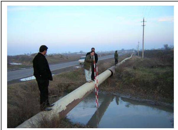
⑨灌漑用水路の堆積土砂実測状況 (サビラバード地区)
