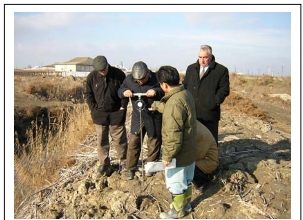
⑫地耐力調査状況 (サートゥリィ地区 メインシルヴァン排水路)
