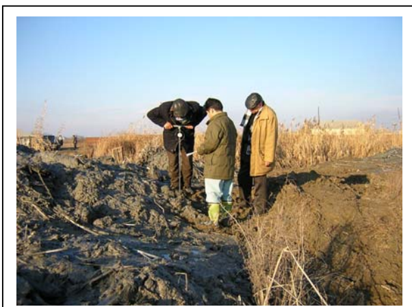
⑪地耐力調査状況 (サートゥリィ地区 メインシルヴァン排水路)
