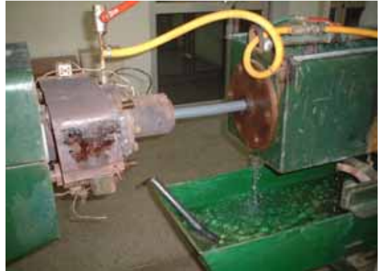
6. PVCパイプの冷却水槽
