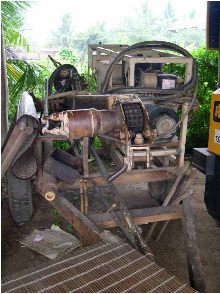
タケオ州地方開発局(PDRD)の保有する掘削機 (DTH 取り付け可能)
