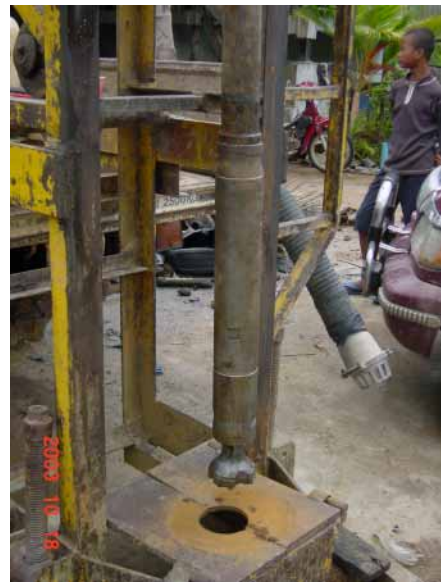
民間井戸掘削会社の大型リグの DTH (DTH:岩盤破碎用掘削方法及び器具)
