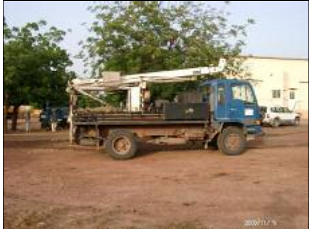
日本調達機材 - 給水施設修理車両 (タンバクンダの維持支部)
