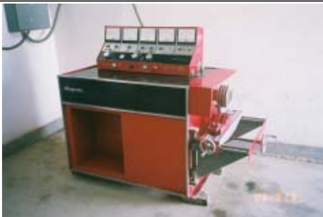
灌漑電力局修理工場に設置されている電動機器類の検査装置 ③⑥
