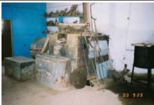
灌漑電力局修理工場に設置されている鋳物部品用溶鋳炉 ③⑥
