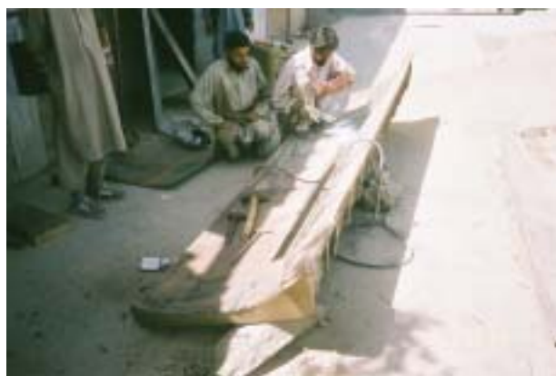
農業組合食糧局修理工場で修理しているブルドーザの排土板
