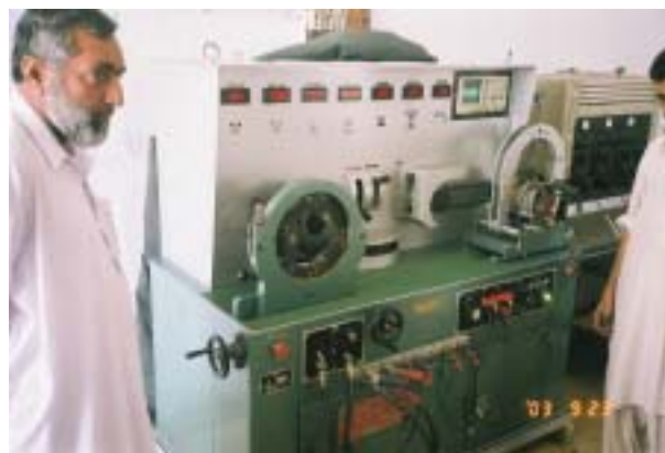
農業組合食糧局修理工場に設置されている電動機器類の検査装置
