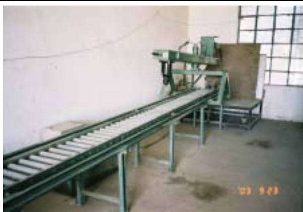
農業組合食糧局修理工場に設置されているブルドーザ等クローラ式重機の足回り部分 (Track Shoe) の修理装置
