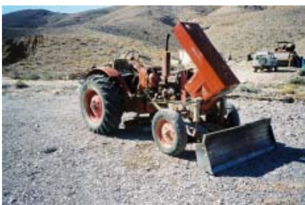
Isplingi DAD 建設現場で使用している排土板付トラクター 同タイプの機材は他の建設現場でも多く見受けられる ③⑨
