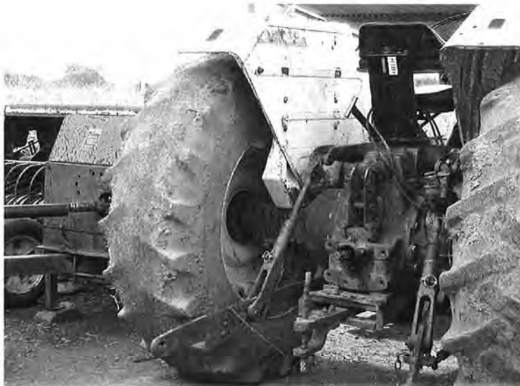
◀小規模農家所有の農業機械現状 (耐用年数を超えている部品等をそのまま使用している)
