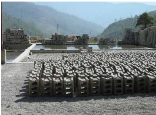
乾燥中のブロックと養生用プール
