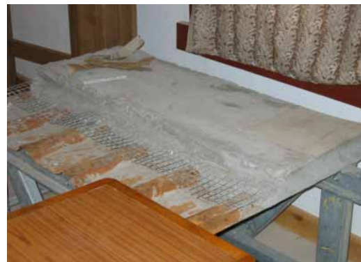
2 階コンクリート床 (厚75mm) の見本
