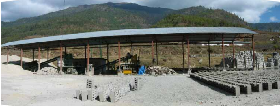
ブロック製造ラインの全景（左側が砂や砂利の資材置場）
