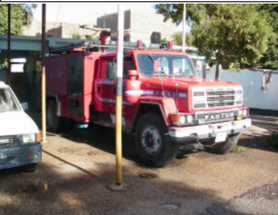
写真5 アスワン県 El Sibayya署 Chemical Truck (化学消防ポンプ車) 1999年、「エ」国製 やや不良 水槽容量少ない(1.5m 3 )
