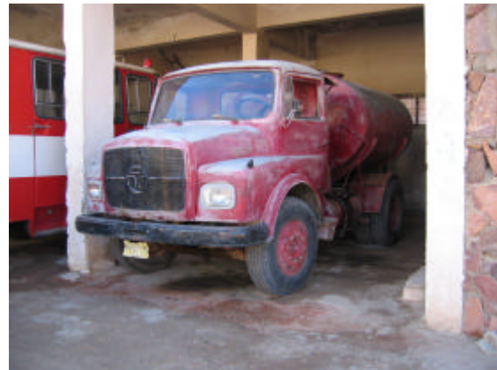
写真8 南シナイ県St. Chatherine署 Water Tanker (小型動力ポンプ付水槽車) 1984年、「エ」国製 やや不良(いつ不良になってもおかしくない) 最高速度約40km/時
