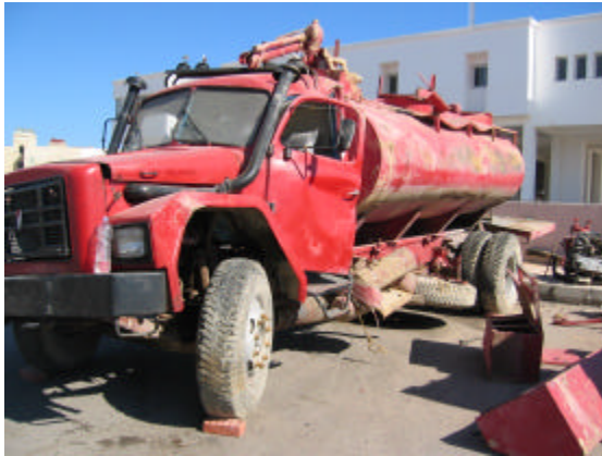
写真7 紅海県Hurghada HQ署 Water Tanker (小型動力ポンプ付水槽車) 製造年不明、「エ」国製 不良 横転事故で大破し廃車
