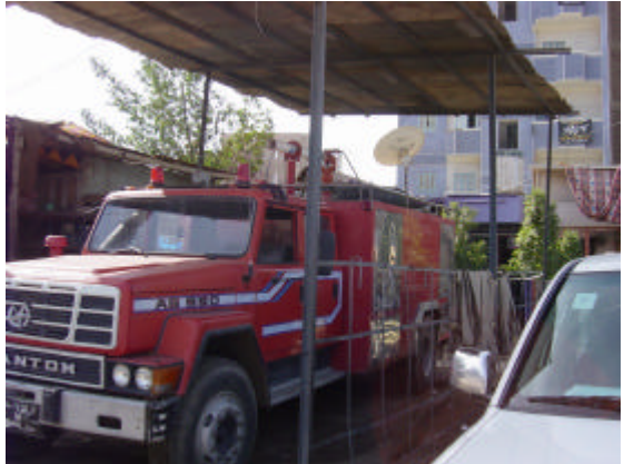
写真4 アスワン県 Idfu署 Chemical Truck (化学消防ポンプ車) 1999年、「エ」国製 やや不良 水槽容量少ない(1.5m 3 )
