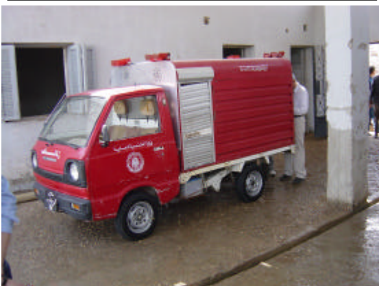
写真11 アスワン県Aswan West署 Pump Truck (小型動力ポンプ積載車) 1999年、「エ」国製 やや不良 水槽を搭載していないため、消防水利の乏しい地域では消火活動が限られる
