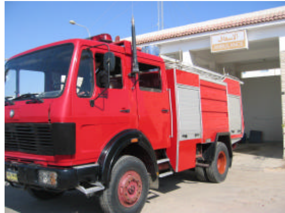
写真2 南シナイ県 Sharm El Sheikh Naama署 Chemical Truck (化学消防ポンプ車) 1984年、イタリア製 やや不良(いつ不良になってもおかしくない) 製造から約20年経過
