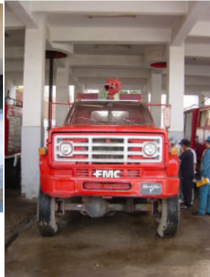
写真8 南シナイ県St. Chatherine署 Water Tanker (小型動力ポンプ付水槽車) 1984年、「エ」国製 やや不良(いつ不良になってもおかしくない) 最高速度約40km/時
