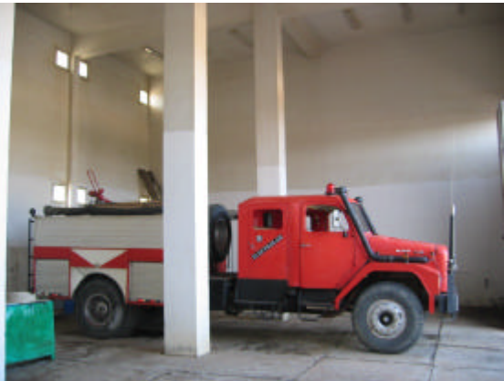
写真3 南シナイ県 Nuweiba El Muzeina署 Chemical Truck (化学消防ポンプ車) 1990年、「エ」国製 やや不良(いつ不良になってもおかしくない) 最高速度約40km/時
