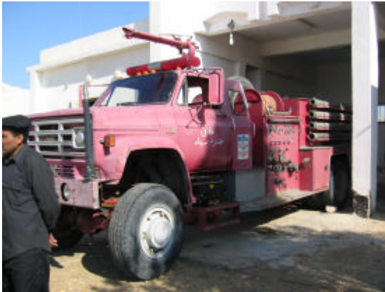
写真1 南シナイ県 Ras El Sudr署 Chemical Truck (化学消防ポンプ車) 1982年、米国製 やや不良(いつ不良になってもおかしくない) 製造から20年以上経過
