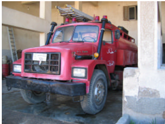
写真9 紅海県Ras Gharib署 Water Tanker (小型動力ポンプ付水槽車) 1997年、「エ」国製 やや不良(いつ不良になってもおかしくない) 最高速度約40km/時
