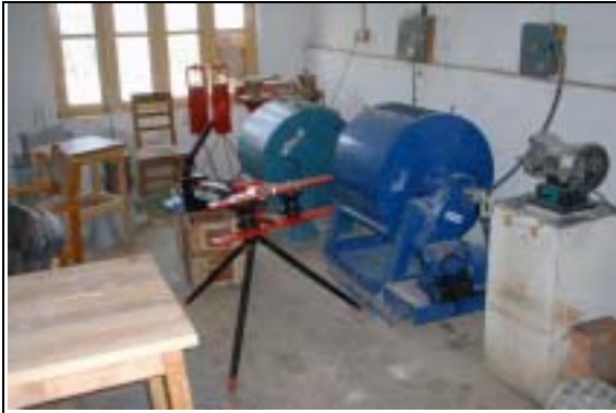
19. 土質・材料試験室内のロスアンゼルス・すりへり試験機
