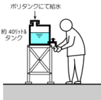
図 3-20 可動型給水タンク
