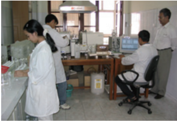
ベトナム「水環境技術能力向上プロジェクト」。専門家（右端）のアドバイスのもと供与された原子吸光光度計をカウンターパート機関の学生が使用している様子。
