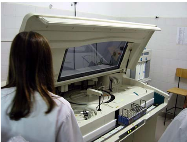
プロジェクト供与機材(自動血液分析装置)： 多検体、多項目が短時間で測定できる本機材の使用によ り、来院する罹患動物の適切かつ迅速な診断が可能となっ た。
