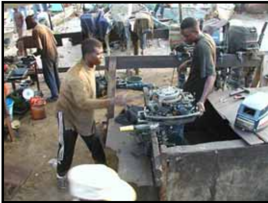
写真 - 17 船外機の修理作業
