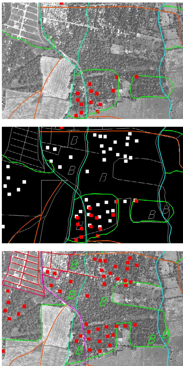
図 4.4-5 既存データ+オルソ、既存データ+新規ラインデータ、編集後のラインデータ+オルソ
