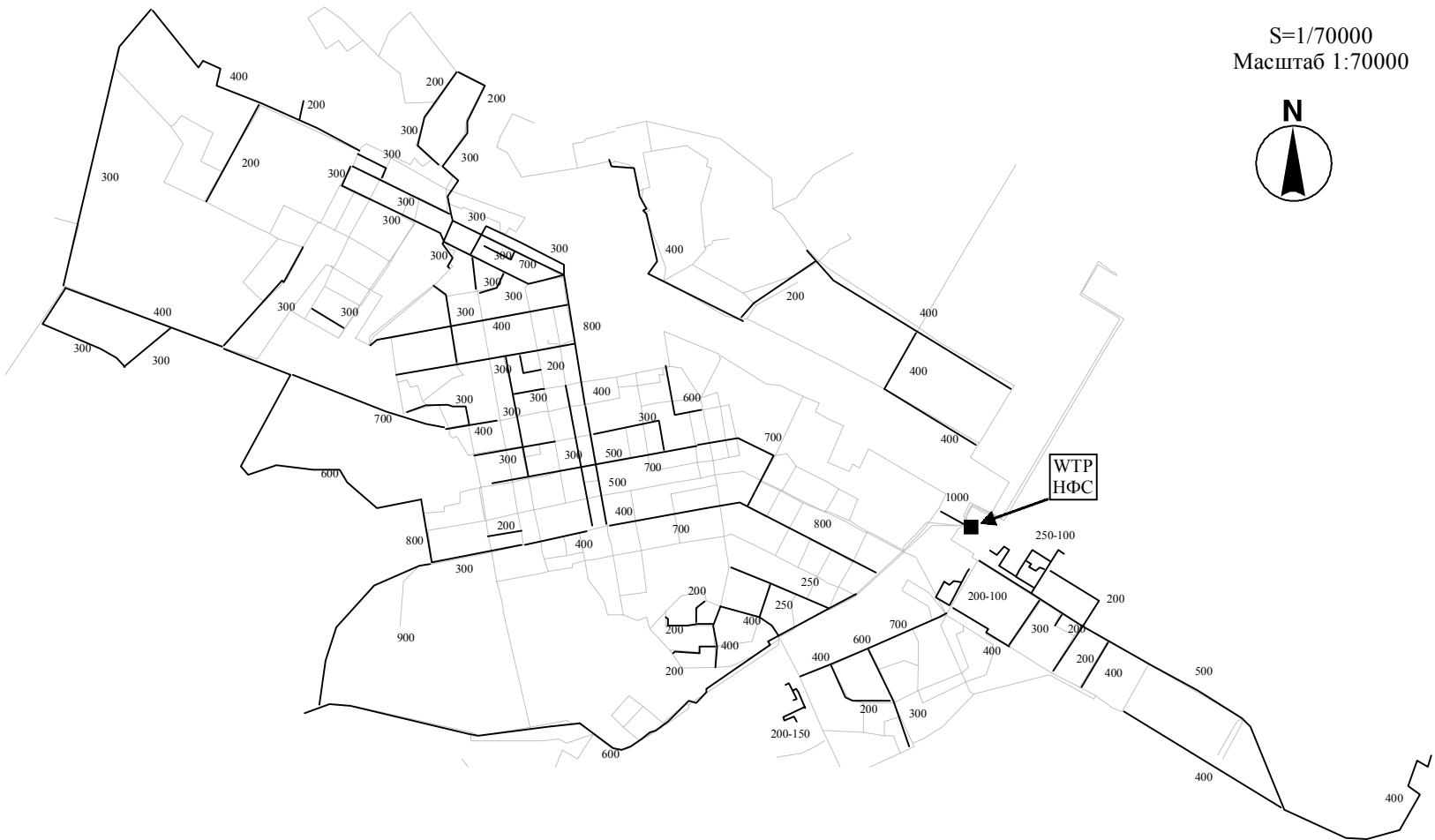
Рисунок 5.4.2 Расположение труб, подлежащих замене
