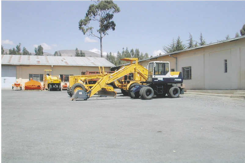
道路建設機械運転操作関連供与機材(左からアスファルトスプレーヤー、チップスプレッダー、タイヤローラー、振動ローラー、モーターグレーダー、ホイール式エクスキャベーター)
