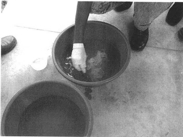
写真15 規定量の水を容器に移し薬剤（錠剤）を投入してよく溶かす
