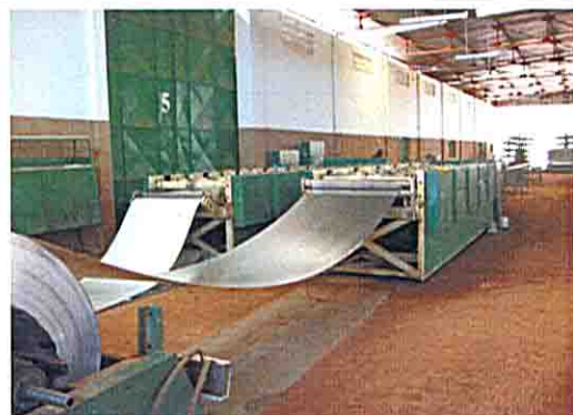
屋根材加工ラインの金属素材
