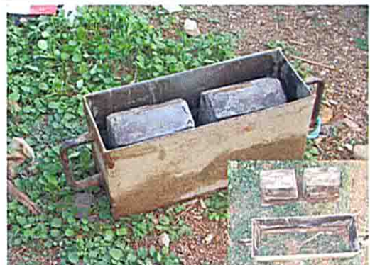
ブロック製作用の金型 (工事現場3)
