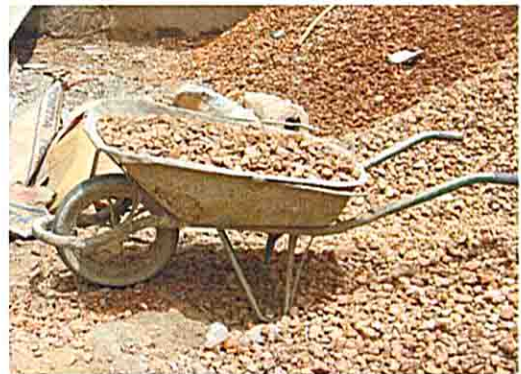
品質の比較的良好な砂利 (工事現場2)
