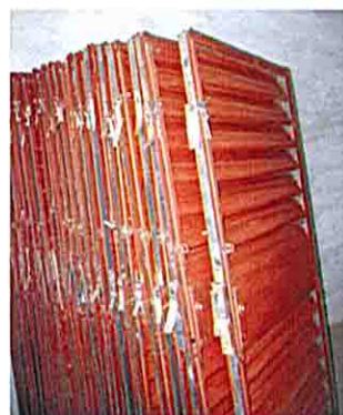
製作中のスチール製建具（2）
