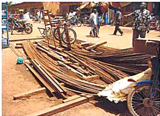
かなり錆びている鉄筋
