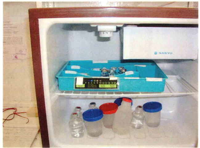
農村保健サブセンター ワクチン保管用冷蔵庫 内部 上部冷凍室はアイスパック凍結に使われる。
