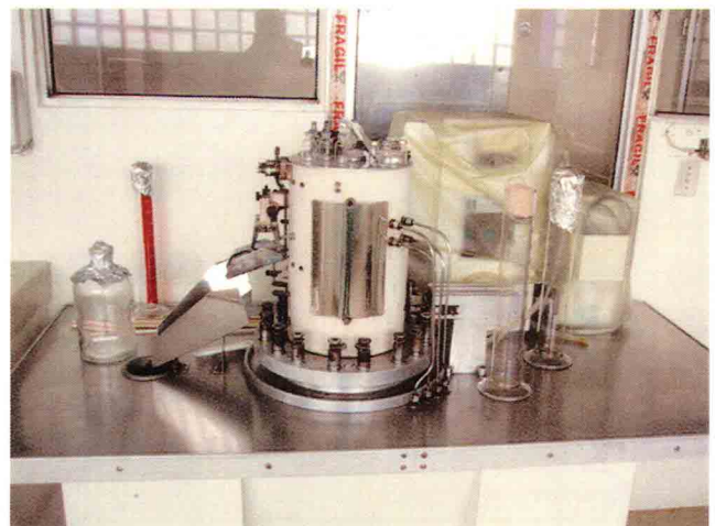
国立衛生熱帯医学研究所 (INH) ワクチン製造棟 内部 老朽化しており使用できない分注機
