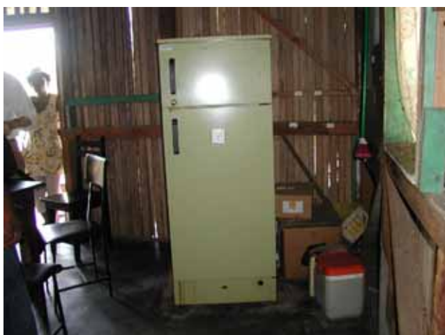
チュレール州ミアリー-CSB2の灯油冷蔵庫 灯油の質が悪くススや残留物がつまるので頻繁に芯を交換している
