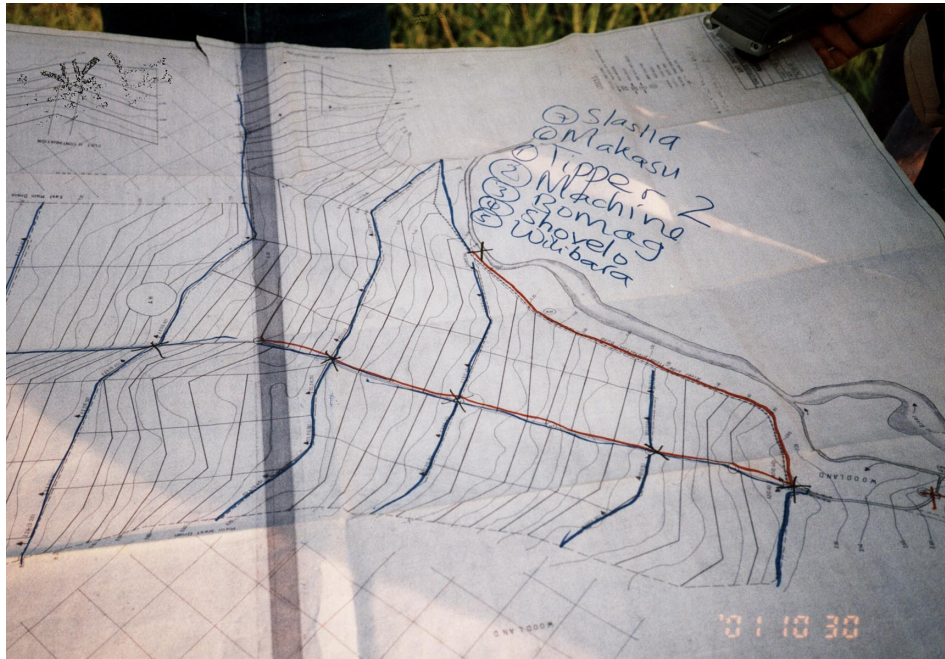
全体図と均平工事のない耕区割り
