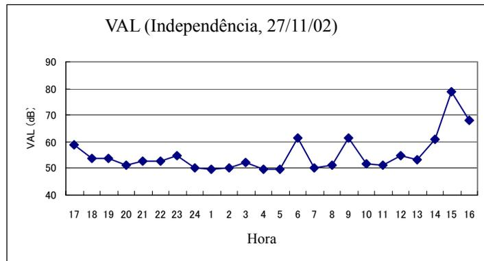
Figura A-64 Resultado da Medida de Vibração (Avenida Independência, 27/Nov/02)
