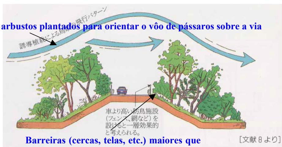
Figura 15.5-6 Exemplos de Acessórios para a Travessia de Animais
