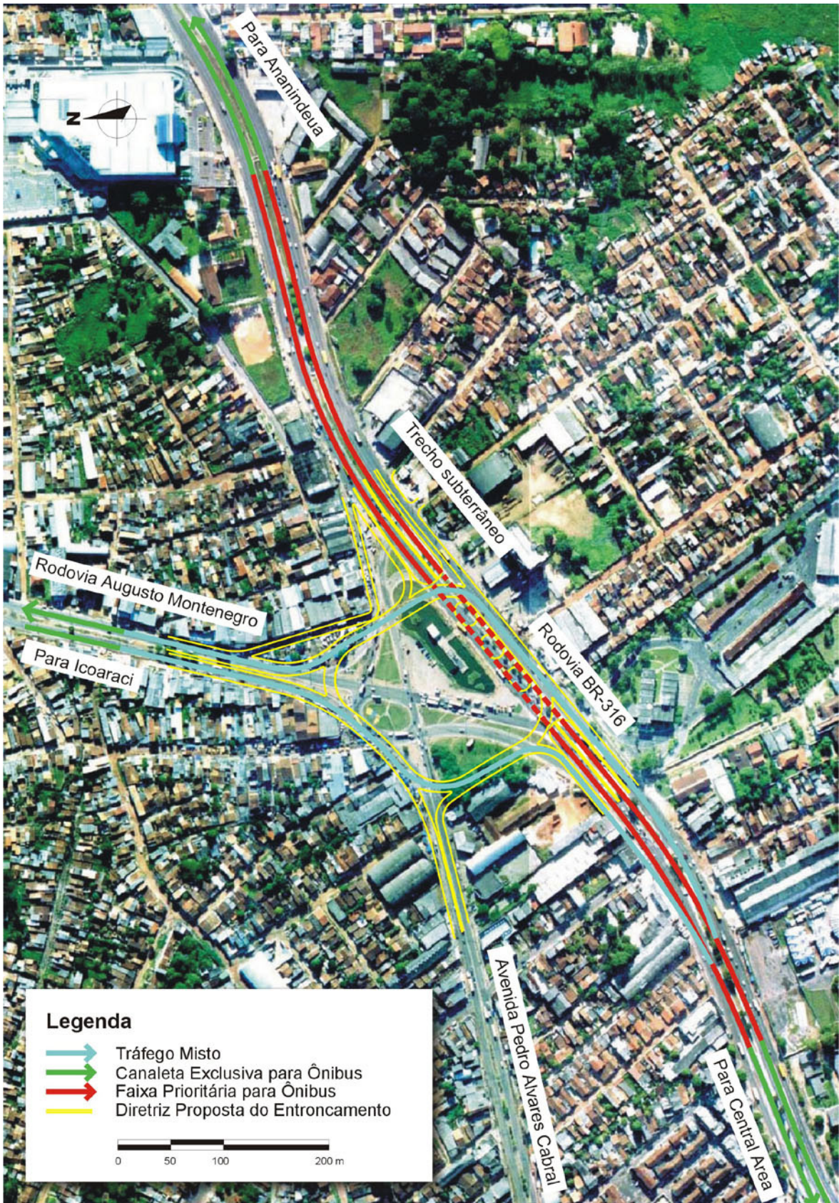
Figura 14.3-8 Plano de Fluxo de Ônibus no Entroncamento
