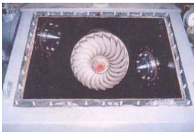
図 3.4 ターゴインパルス水車の内部
