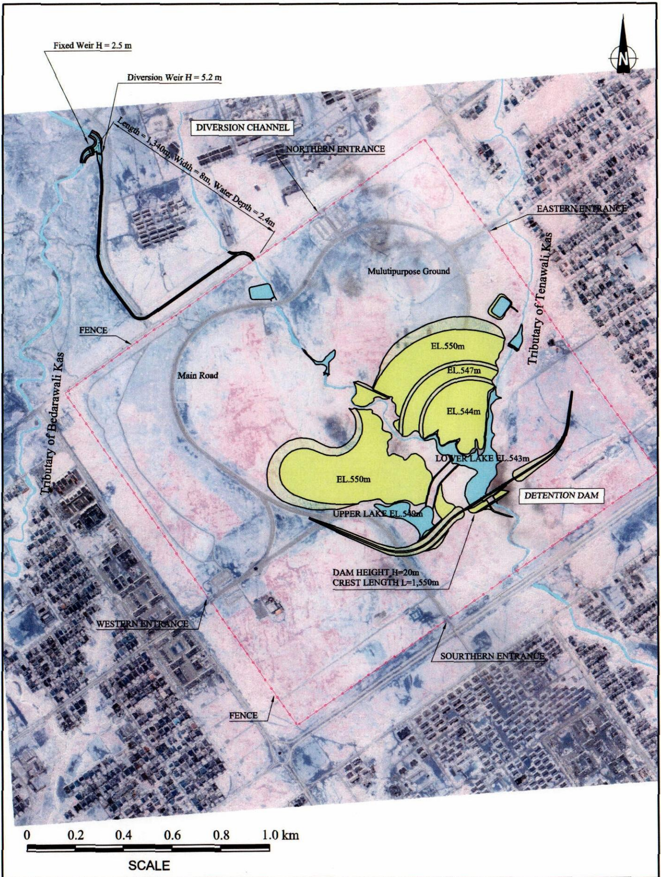
図 16 ベダラワリカス川支川からの 分水路の平面配置計画
