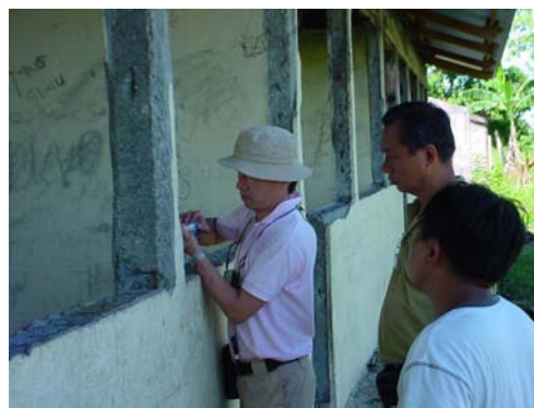
コンクリート強度試験
