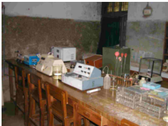
検査室 写真の中央に分光光度計、その左に半自動 分析装置、右奥には電子天秤が設置されて いる。いずれも使用可。
