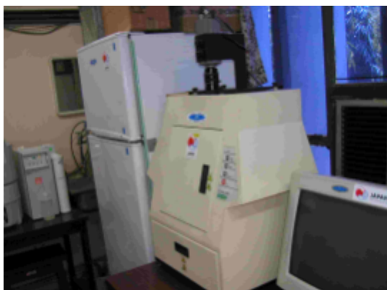
微生物学ラボ：電気泳動ゲル撮影装置 両側に冷蔵庫とパソコンが設置されており狭隘な室内であることがわかる。
